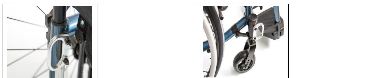
Fixations de transport (œillets arrière et avant) à l'exclusion des systèmes d'attache à nœuds de force. L'assemblage des éléments du système de fixation par nœuds de force sur le fauteuil roulant ne peut pas être facturé via le tarif du fauteuil roulant.
